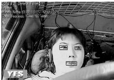
図6 対話相手の人の顔を見る．運転中のドライバーとのマン・マシン対話実験の一場面．機械が人を見ている．顔とその中の口と目を検出し，音声認識システムを駆動する．図中にコンピュータが検出した目と口，応答した返事(「YES」を示す)(図提供：森健策名古屋大学助教授)
