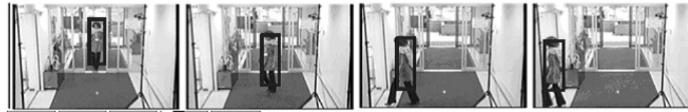
図 14 体の向き変化が生じるようなシーンでの人体追跡の結果 Fig. 14 Example of human body tracking with pose variation.
