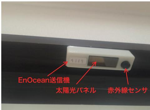
図 2 エナジハーベスト焦電型赤外線センサ
