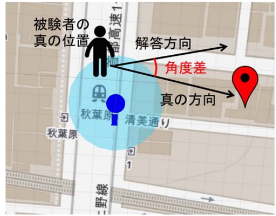
図 8 評価基準「解答方向と真の方向との角度差」の視覚的説明
