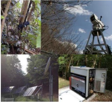
図1 ユビキタス型のリアルタイム環境音配信システム (シンクノード)
