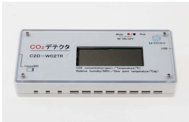
図3 UDOM社製 CO2 デテクタ C2D-W02TR
