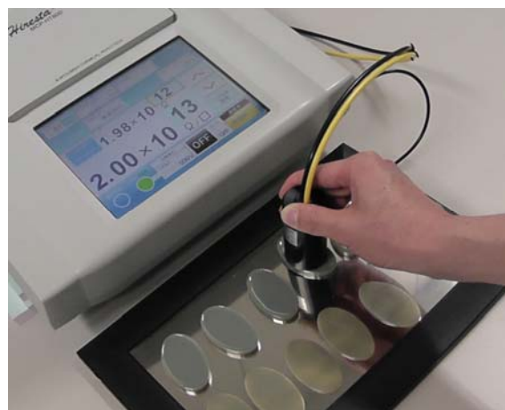
図 5 高抵抗計による抵抗値の測定 Figure 5 High Resistance value measuring.
