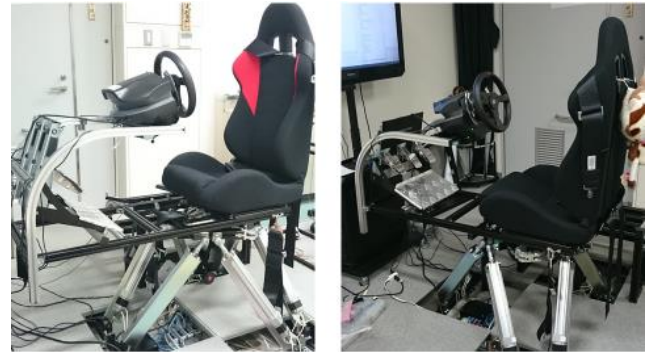
図 8 6 軸モーションベース Figure 8 Six axis motion base.
