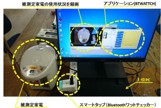
図4 被測定家電の消費電力の測定風景
