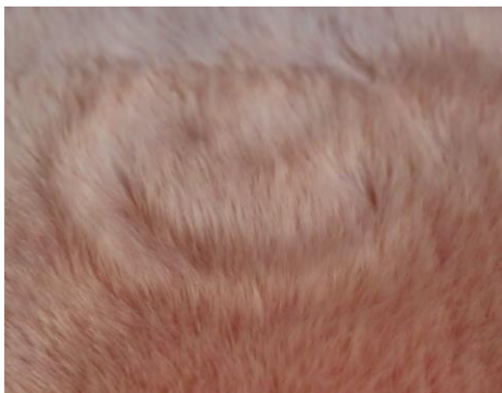
図8 超音波投射を用いた起毛素材への描画
