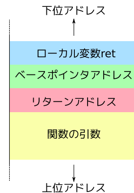
図 2 関数の呼び出し時のスタックの構成 Fig. 2 Structure of a stack at calling a function.
