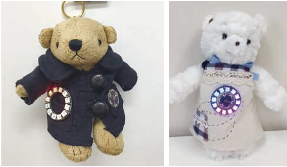
図-8 明暗でNeoPixel LEDの光り方が変わるマスコット
