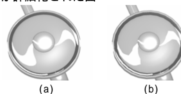
図 4.3 反射線表示(a)通常例, (b)粗くした例
