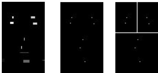
(a) エッジの合計 (b) (a) の中心点 (c) 部位候補の領域 図3 顔部位候補
