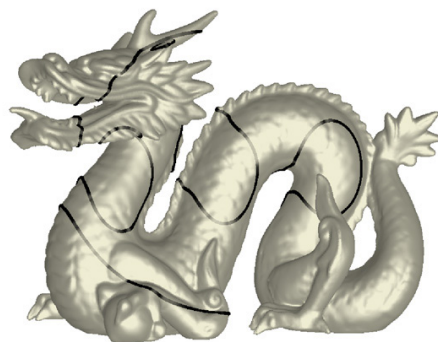
図 1: 陰関数曲面の衝突ループ検出の例.
