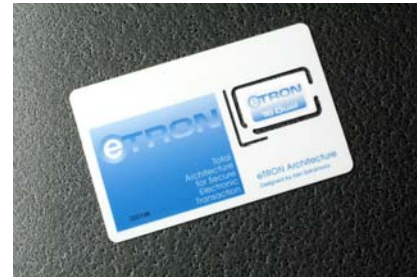
図 1: 開発した SIM カード型 eTRON/16 チップ
