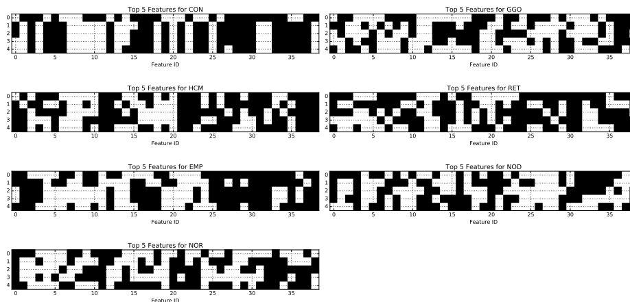
図 5 CV スコア上位 5 つで選択された特徴量の組合せ。横軸は特徴量番号、縦軸は順位をそれぞれ示している。黒マスは各クラスにおいて選択された特徴量の場所を表している。左列の図は CON, GGO HCM, RET クラスの、右列の図は EMP, NOD, NOR クラスの結果にそれぞれ対応している。
