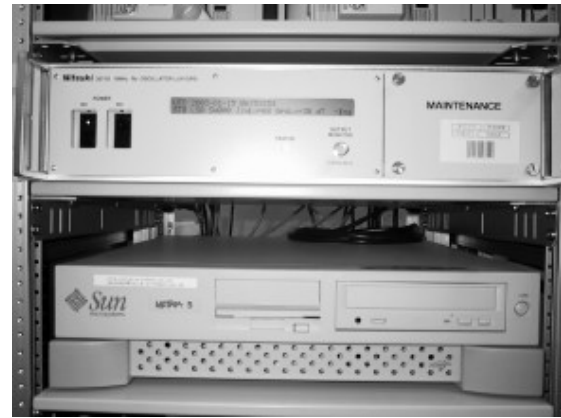
図2 基準信号発生器およびワークステーション
