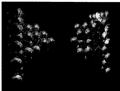
図3. 金ナノコンタクトの引張切断シミュレーション
