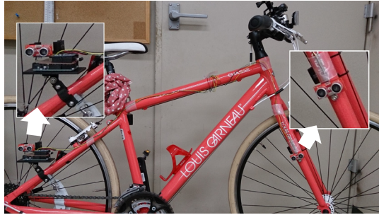
図1 前輪側と後輪側のフレームに超音波センサをつけた自転車
