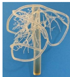
図3:本システムを用いて生成し、3Dプリンタで出力したフレーム構造の簡易臓器モデル
