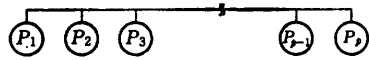
図2 ブロードキャストバス結合形一次元プロセッサアレイ Fig. 2 A broadcast-bus connected one dimensional processor array.
