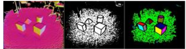
図1 平面抽出の流れ（左：法線ベクトルマップ，中央：法線ベクトル勾配画像，右：平面領域抽出画像）
