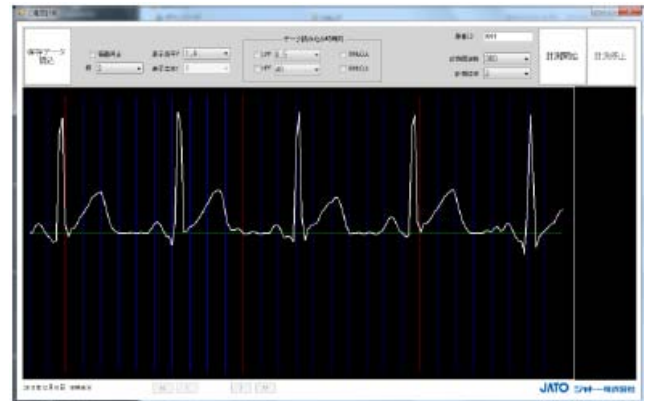
図 9 試作したシステムで観測した波形 Figure 9 Measured ECG by prototype system.
