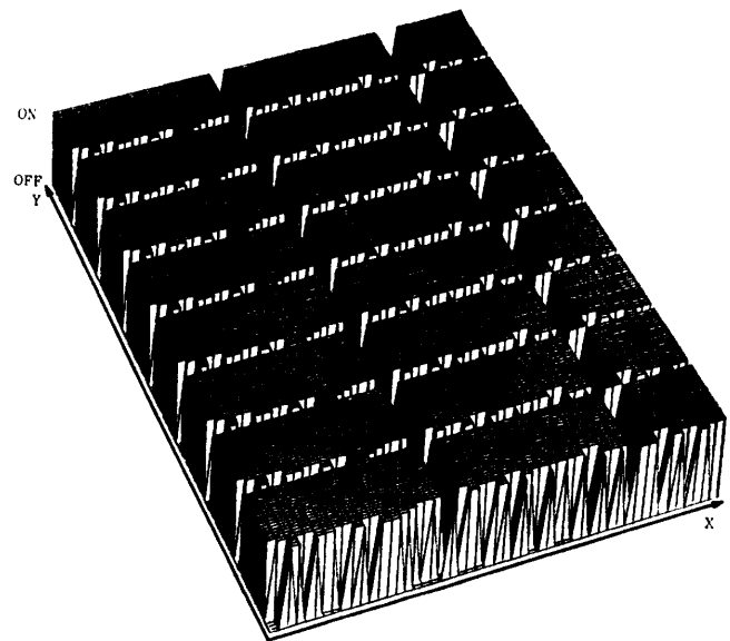
図 16 TFADDER 回路を構成するタスクの MOSPLUS 上における処理状況 X: タスク番号, Y: ユニットタイム Fig. 16 Executing task states for TFADDER on MOSPLUS.
