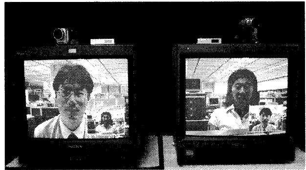
図 4: ISIL-BOX を用いた双方向映像コミュニケーション - 相手画像と自画像を表示 (4Mbps/Full-D1) -
