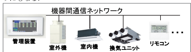
図 2 設備機器システム（空調）のイメージ
