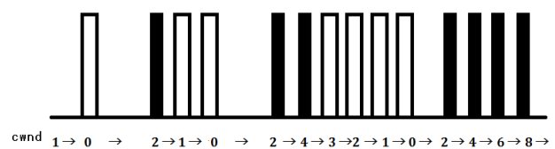
図2.2 パケットフローとその輻輳ウィンドウの推移
