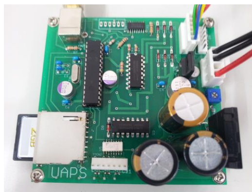
図10 完成したインターフェースボード
