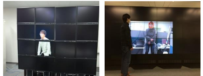
図8 背景切り替え機能と顔の大きさを基準とした等身大表示機能の例
