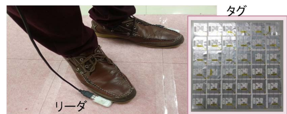
図 2: 床面に敷き詰められたタグ及びリーダ装着状況
