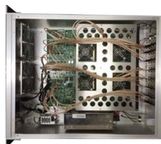
図2. 時空間解像度変換装置 (19吋 EIA 4U サイズ)
