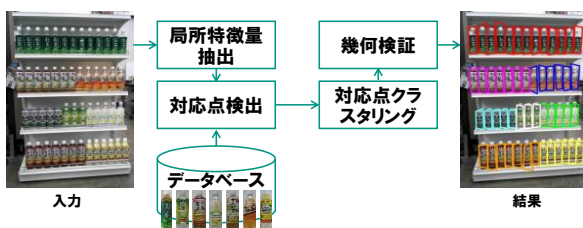
図 1 大量のモノを識別する画像認識技術のブロック図
