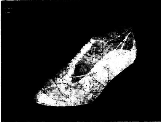
図 16 デザイン線およびラストのシェーディングモデル Fig. 16 Design lines and shading model of Last.
