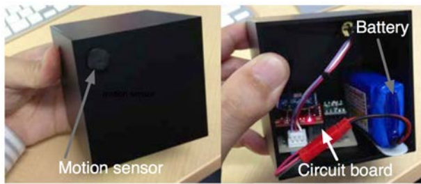
図2: センサユニット筐体外観図, 内部図
