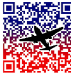
図3 誤り訂正能力を利用したデザインQRコード(文献[5]より引用)
