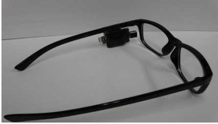
図 1 小型 USB カメラを取り付けたメガネ
