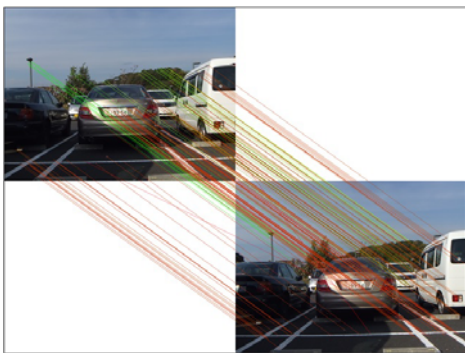
図5 画像間の対応点の例(距離 5.0m,線は対応を示す)
