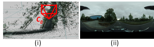
図2: 車載型三次元計測システムにより取得した情報 (i) 三次元点群と全方位画像の撮影位置・姿勢 (ii) C_0 地点で取得した全方位画像
