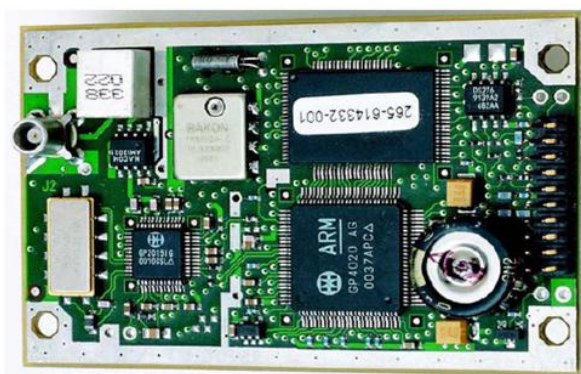
図5 プロトタイプ GNSS 受信ボード Figure5 Superstar-II GNSS Receiver Board
