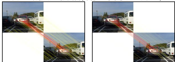
(a)特徴点抽出パラメータ 100 (b)特徴点抽出パラメータ 1000
