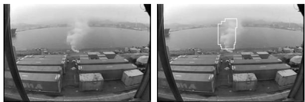
図 2 Movie2 での検出結果例 (左:元画像, 右:検出された煙領域, 累積時間 6 秒, 煙判定閾値 6 秒)
