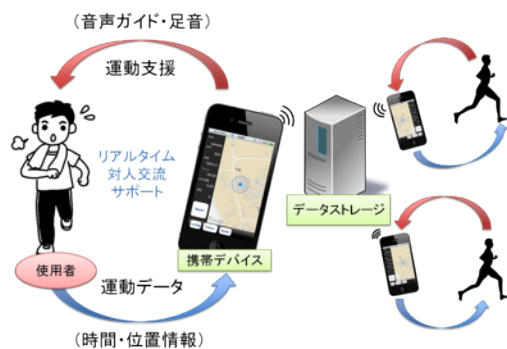
図 1: 仮想ランナー提示システムの構成図
