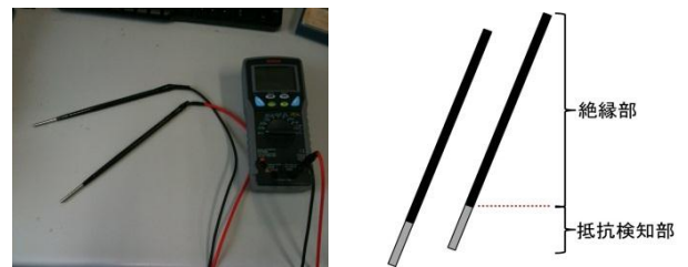
図2. 箸に DMM を装着した図、デバイス構成図
