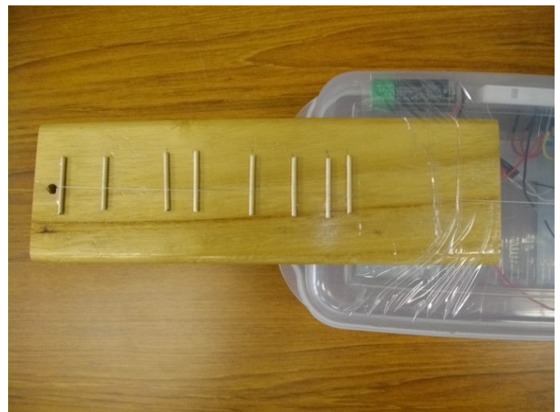
図2 ネックとフレットの取り付け図
