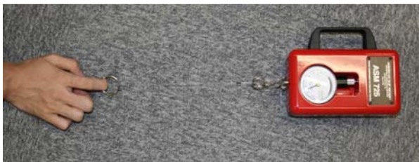
図 6 静摩擦係数の測定
