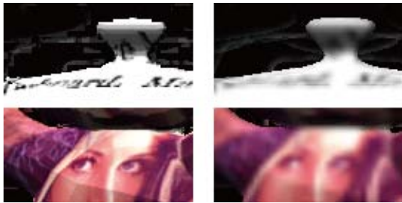
図1 縮小によるデータ量削減で発生するノイズ 左: (a)デプスマップを縮小 右: (b)多視点画像を縮小
