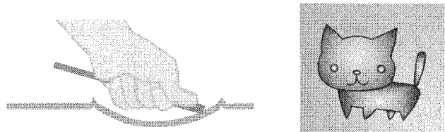
図2 へら出しによる銅板の浮き彫り
