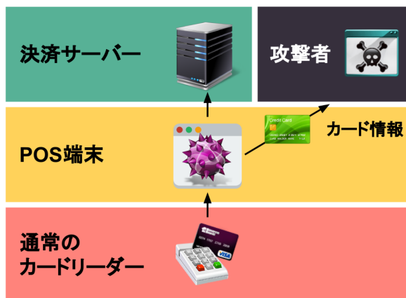
図 1: POS マルウェアによるカード情報窃取の流れ
