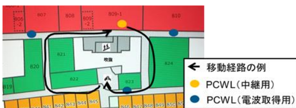
図 6 PCWL の設置位置 Figure 6 Placement of PCWL
